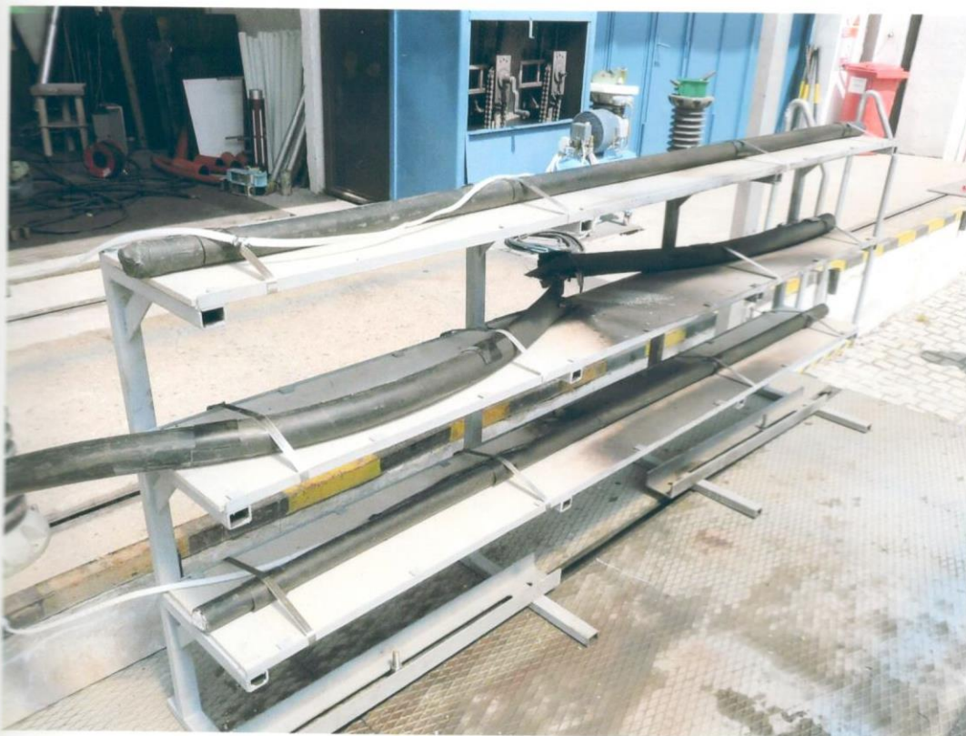
Obr. 3 Zkušební vzorek po zkoušce obloukovým zkratem na zkušebním kabelu vn
